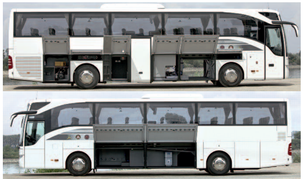
▲ Im Kofferraum ist genug Platz für das Gepäck von 49 Passagieren. Parallelklappen sind Option. In Zusatzfächern lässt sich Zubehör und Verpflegung unterbringen
