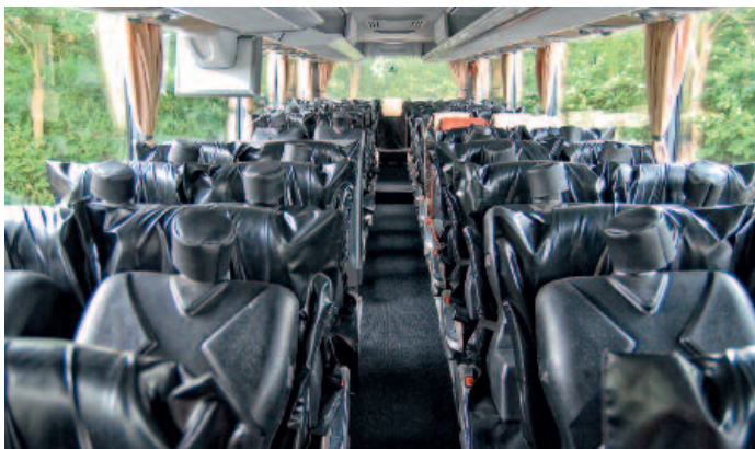
▲ Zur praxisgerechten Verbrauchsmessung war der Tourismo ab Werk mit Wasserkanistern auf den Sitzen ausgelastet. Das Testgewicht betrug 17,6 t
