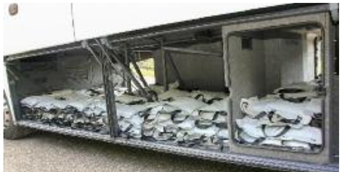
⬆ Ausreichend bemessen ist der Kofferraum mit der als Stauraum nutzbaren Fahrerschlaflkabine (r.). Manko für die Testprozedur: MAN musste aus Zeitgründen auf Wasserdummys auf den Sitzen verzichten, so dass der komplette Ballast hinter den Klappen tief unten im Fahrzeug verteilt war
