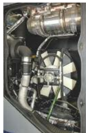
▲ Die Euro-6-Komponenten brauchen Platz und verursachen ein Mehrgewicht gegenüber dem Vorgängermodell von rund 300 kg
