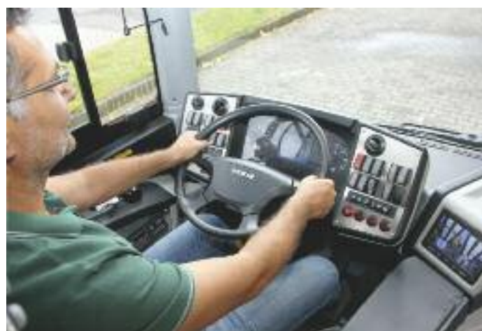
▲ Nicht mehr zeitgemäß: die Armaturen von Actia. Rechts der Monitor zur Überwachung der beiden hinteren Ausstiege
