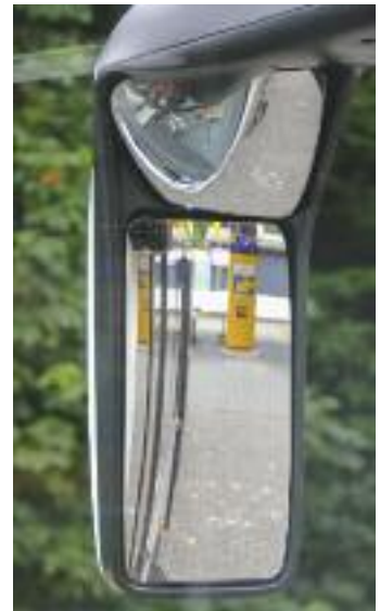
▲ Gute Sicht nach hinten und auf die Front bietet der rechte Außenspiegel des Kent
