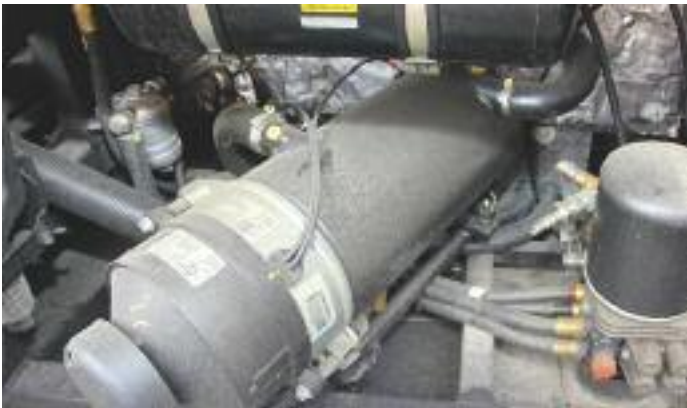
▲ Zentral im Motorraum war noch reichlich Platz für die Standheizung von Eberspächer mit einer Leistung von 30 kW
