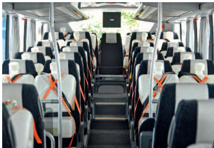
▲ Präpariert für die Verbrauchsmessung: Der Testbus war mit 3 500 t Ballast beladen. Auffallend sind die ansteigenden Sitzreihen ab Tür 2 bis zum Heck – weshalb die Gepäckablage zwecks Kopffreiheit an der vorletzten Reihe endet
