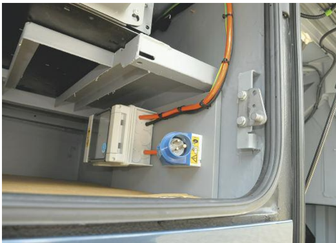
▲ Unser Testbus hatte ein kleines E-Werk an Bord: mit Konverter- und Inverterfunktion, zur Umwandlung von Wechselstrom (230 Volt) in Gleichstrom (24 Volt) sowie umgekehrt Foto: Görgler
