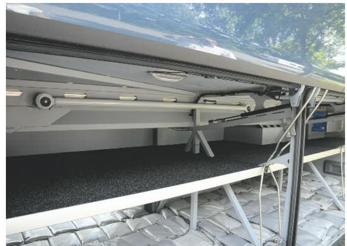
▲ Der große Kofferraum lässt sich durch den doppelten Boden noch besser nutzen. Im Hintergrund am Mittelträger hat die Abschleppstange ihren festen Platz Foto: Görgler
