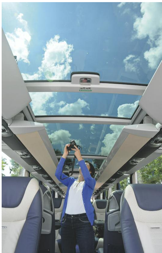
▲ Foto gefällig? Das Panoramaglasdach TopSky gewährt Durchblick nach oben und sorgt für einen hellen Innenraum Foto: Görgler
