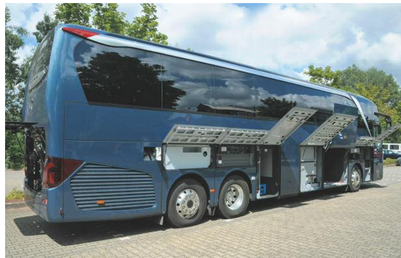
▲ Jeder Winkel genutzt: Im Reisebus kann man nicht Stauraum genug haben. Zudem müssen Schaltkästen und sonstige Einrichtungen ordentlich untergebracht sein. Die häufig genutzte Klappe für den Gepäckraum lässt sich parallel öffnen
