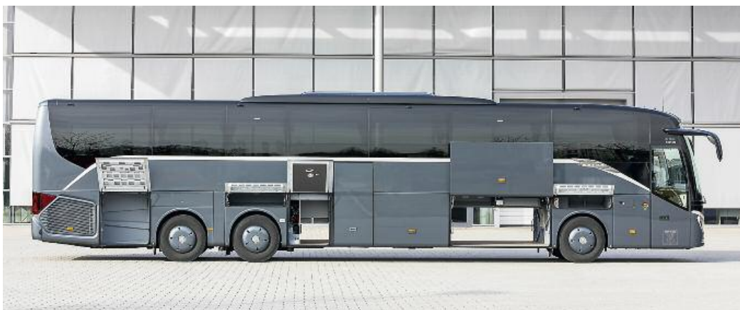
↗ Angesichts eines Stauraums von 11,2 m 3 konnte der Testbus schon einiges wegpacken Foto: Daimler AG
