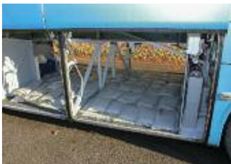
← Dank Heckeinstieg entsteht ein unverbauter, großer Kofferraum mit einem Volumen von fast 8 m 3 Fotos: Bünnagel
