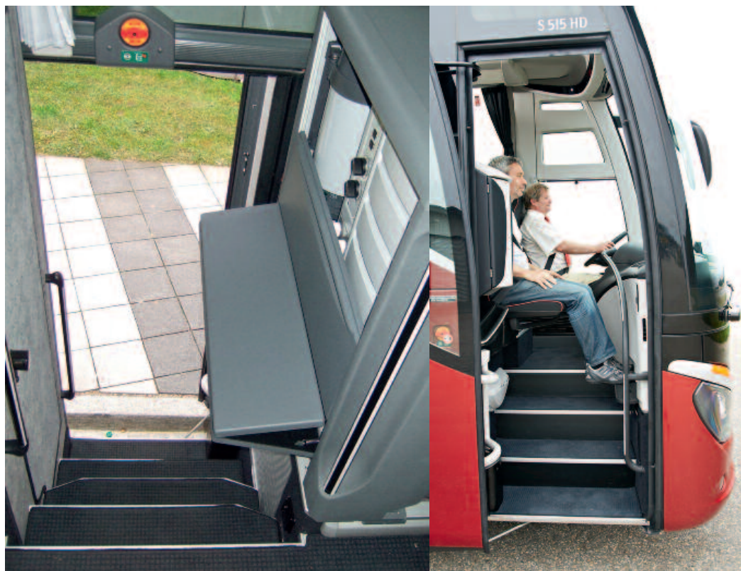
▲ Der vordere Einstieg der ComfortClass 500 (r.) wurde deutlich vergrößert. Auch der mittlere Einstieg ist angenehm breit, selbst wenn die dort eingebaute Miniküche von TM geöffnet wird
