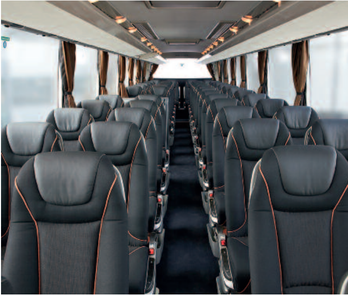
▲ Reduziert und doch edel wirkt der Passagierbereich, auch dank der auf Aluminiumprofile aufgelegten Stoffdecke
