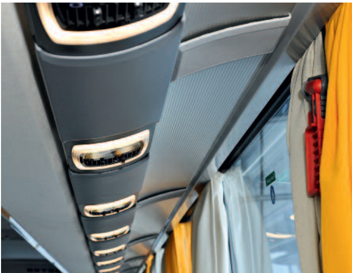
▲ Die Lautsprecher sind auf Höhe der Fenstersäulen in die Luftkanäle integriert. Das ergibt einen angenehmen Raumklang
