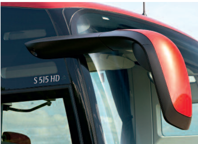
▲ Der modellierte Spiegelarm mit der aus dem Flugzeugbau adaptierten Anbindung soll die Windschlüpfrigkeit verbessern
