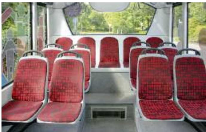
▲ Das ist doch mal ein Anblick in einem Stadtgelenkbus! Ohne Motorturm wird der Heckbereich deutlich attraktiver für die Fahrgäste
