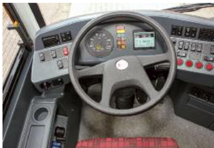
▲ Rechts am Lenkrad, etwas verborgen, befindet sich der Hebel der Elektrobremse, da, wo normalerweise der Retarderhebel seinen Platz hat
