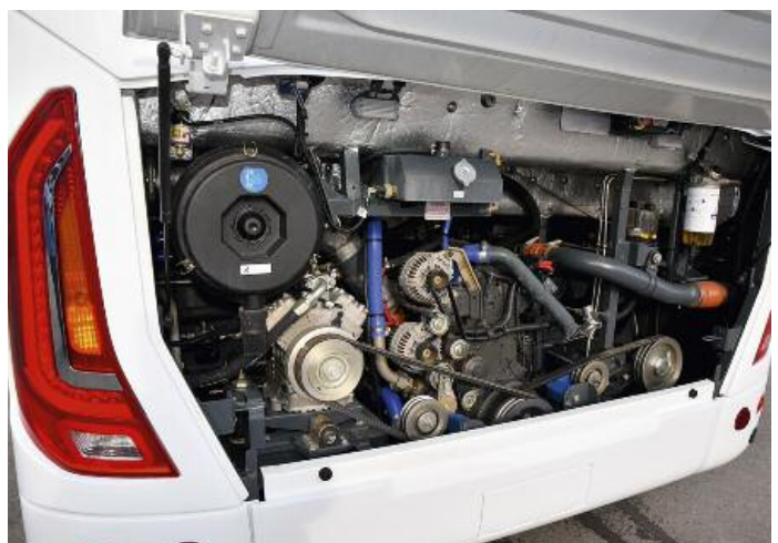
↑ Der 7-l-Motor bietet insgesamt 320 PS an Leistung
