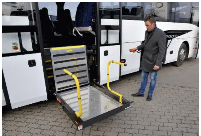
↑ In den angenehm flachen Stufen der hinteren Doppeltüre verbirgt sich ein ausgewachsener D'Hollandia-Lift
