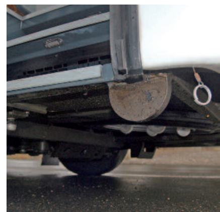
▲ Die kräftige Kufe vorne schützt bei Aufsetzern vor Schäden an Front und Einstieg. Dahinter ist das Ersatzrad verstaut, das sich herunterkurbeln lässt und sich Rollen ausgestattet ist
