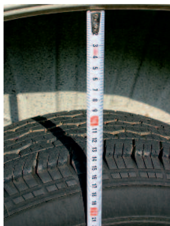
▲ Ein gehöriges Spaltmaß ermittelten wir trotz nur knapp 70%-Ausladung zwischen Reifen und Radkästen
