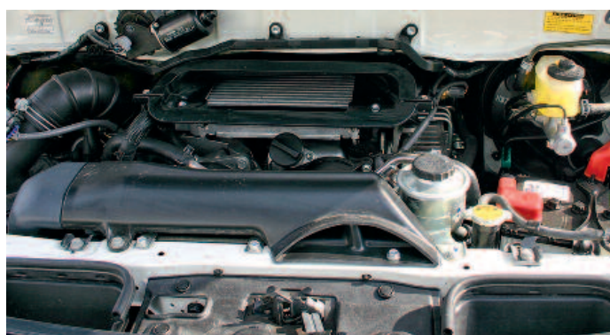
▲ Nichts zu meckern gab es beim 2,5-l-Turbodiesel mit 86 kW, der auch am Berg noch durchzugsstark ist
