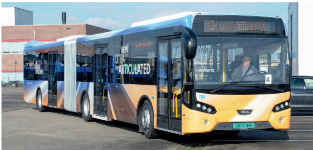
▲ Lange erwartet, nun in zwei Fahrzeuglängen verfügbar: der Gelenkbus Citea SLFA-180 mit einer Kapazität von mindestens 51 Sitz- und 100 Stehplätzen Foto: Görgler
