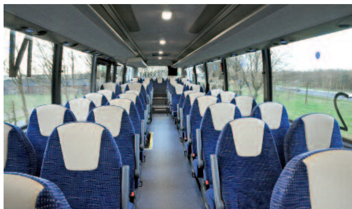
▲ Aufgeräumt und komfortbetont präsentiert sich der Innenraum des Kombibusses. Die Stühle sind podestlos montiert – eine Erleichterung gerade für ältere Fahrgäste Foto: Görgler
