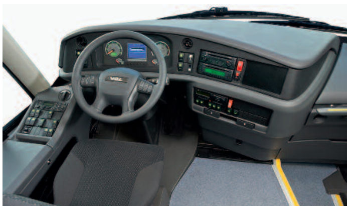
▲ Schnörkellos, funktionell und modern mit guter Sicht nach vorne und zu den Seiten: das Cockpit im neuen Futura FMD2. Neu ist unter anderem das Multifunktionslenkrad Foto: Görgler
