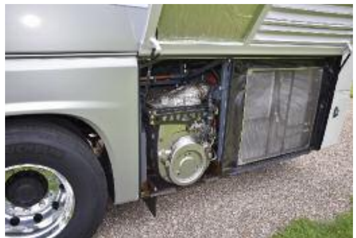
➔ Über die Fahrzeugflanken gelangt man zum Kühler Foto: Olaf Forster
